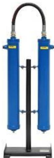
Фильтрационный модуль предназначен для тонкой очистки сжатого воздуха и различных газов, от аэрозолей масла и влаги, а также от твердых частиц размером более 10 мкм. Обеспечиваемое остаточное содержание аэрозоля масла - менее 16 мг/м<sup>3</sup>. Используется в системах пневмоуправления и автоматике, пневмоприводе устройств и инструмента для окраски поверхностей распылением.
