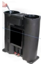
*Совет: предварительное распыление воды на чёрный элемент колонны 2 предотвратит распространение угольной пыли.*
